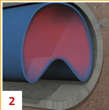
2 Etter installasjon tilføres damp og trykk, slik at røret folder seg ut.
