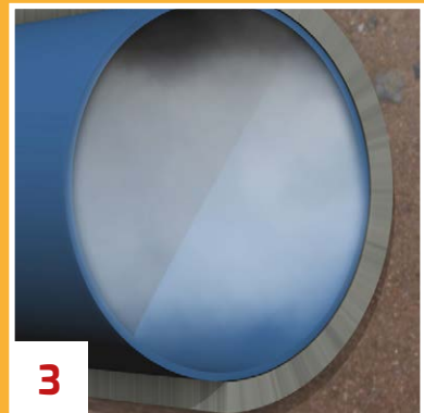
3 Resultatet er et nytt plastrør som sitter tett inntil den gamle rørveggen.
