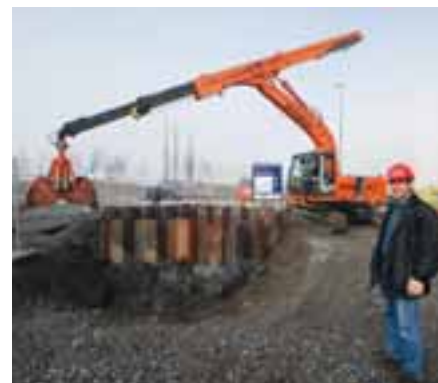
Prosjektleder Arne Valle er godt fornøyd med den nye gravemaskinen med teleskopisk stikke.
